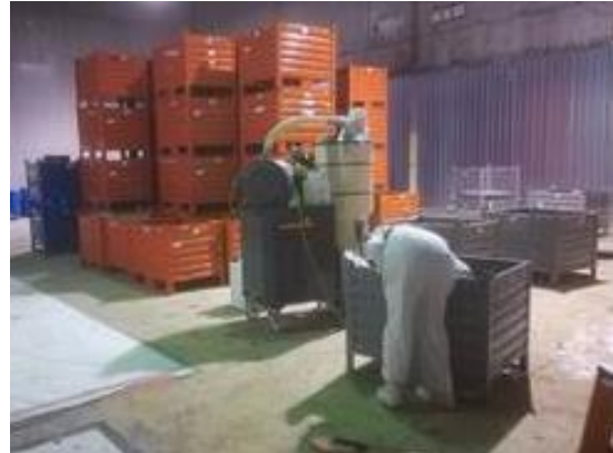
Figura 2-49 – Decontaminazione ad umido dei cassoni
