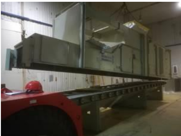
Figura 2-50 – Smontaggio macchina Pallinatrice
